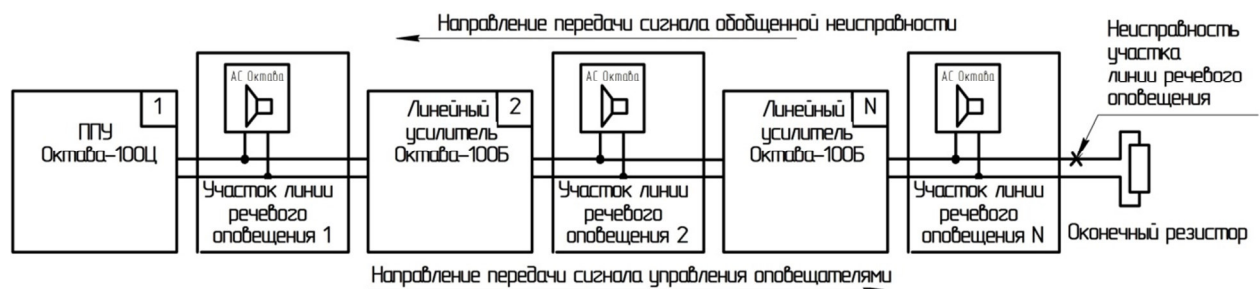
Рисунок 3.2 - Схема передачи сигнала «Неисправность» по линии речевого оповещения
